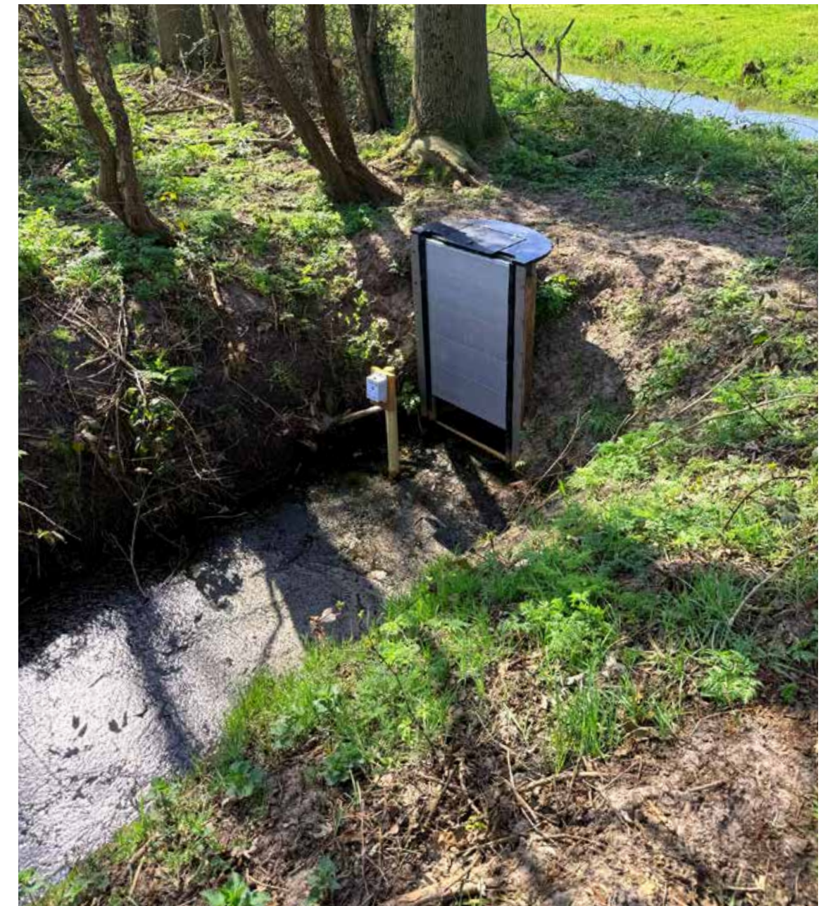
Stuw en daarvoor een multiflexmeter in een zijslot van de Nederwoudse Beek
